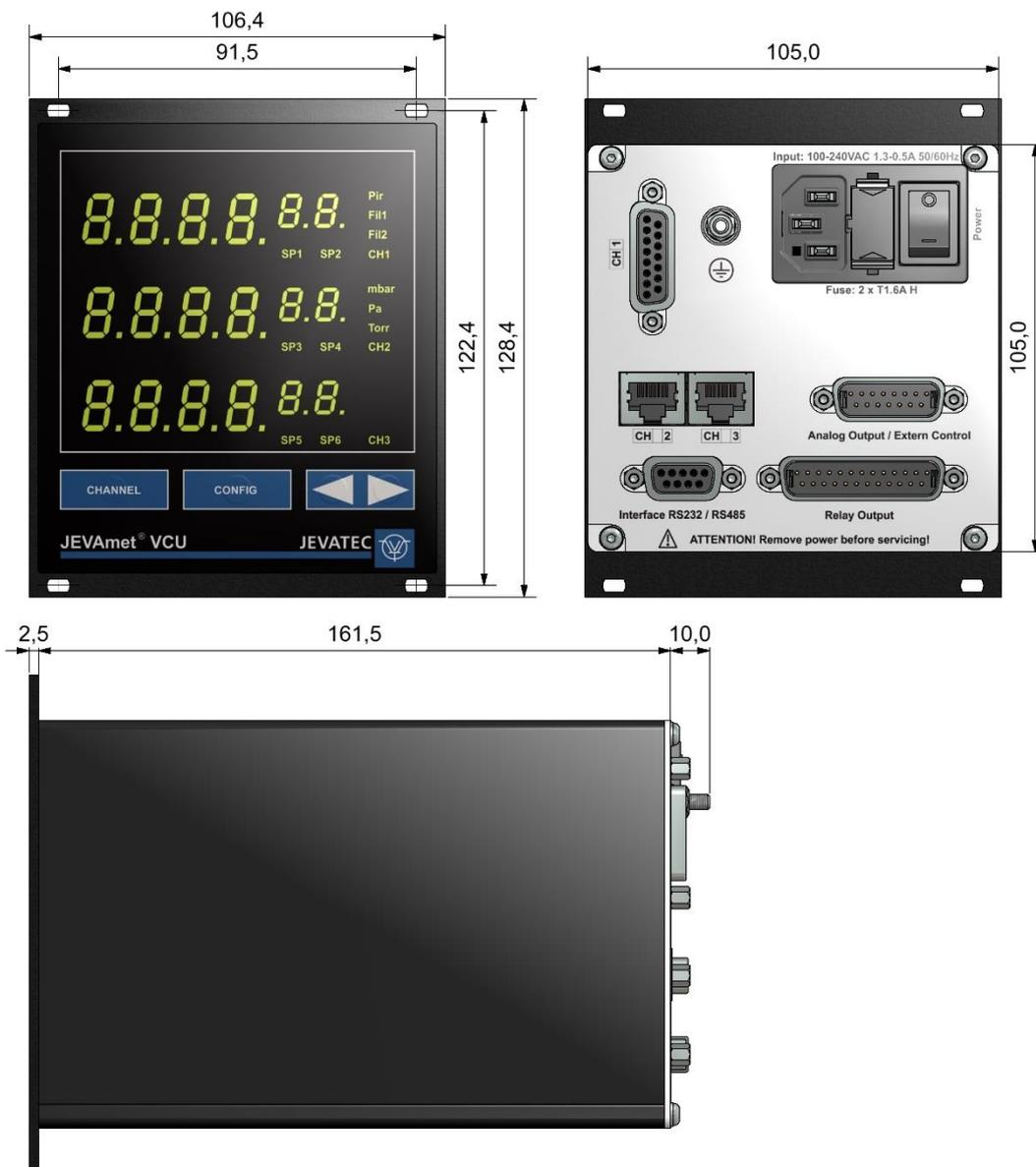
Abbildung 1 – Abmessungen JEVAmet® VCU (in mm)
